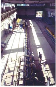
Предназначен для получения профильных труб (квадратных и прямоугольных) из круглых заготовок (электросварных труб).
